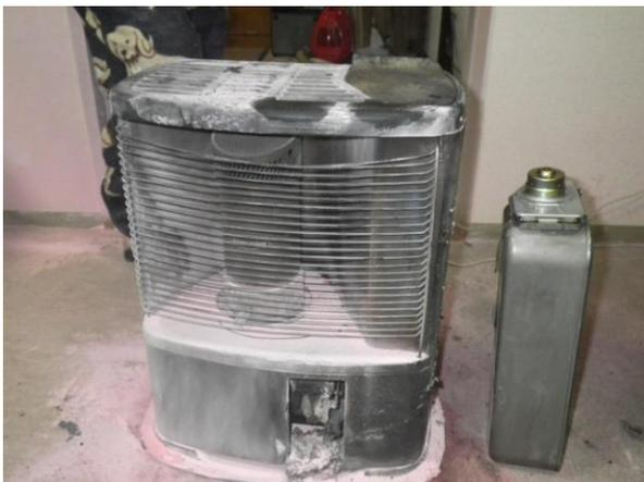
写真 2-2 ストーブ上部の焼損状況
